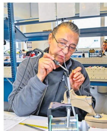
Hier wird ein Kabel gelötet.
