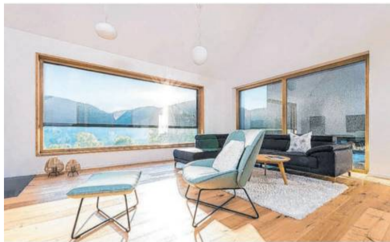
Textilscreens bieten Hitzeschutz und trotzdem genug Tageslicht für eine natürliche Raumatmosphäre sowie eine gute Durchsicht nach draußen.
