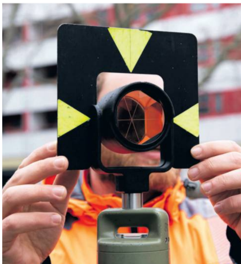
Vorbereitung für die Baustelle: Vermessungstechniker bestimmen Lage, Neigung und Höhe eines Grundstücks. Mit den Daten zeigen sie an, wo Grundstück gebaut werden soll.
